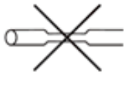
Csökkentse az átmérőt a csomóponti részről
